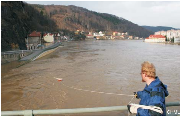
Abb. 4.2-2: ADCP-Durchflussmessungen an der Elbe in Děčín – Hochwasser 2006
